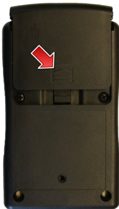
Rys. TachoReader Combo Plus - wymiana baterii.
