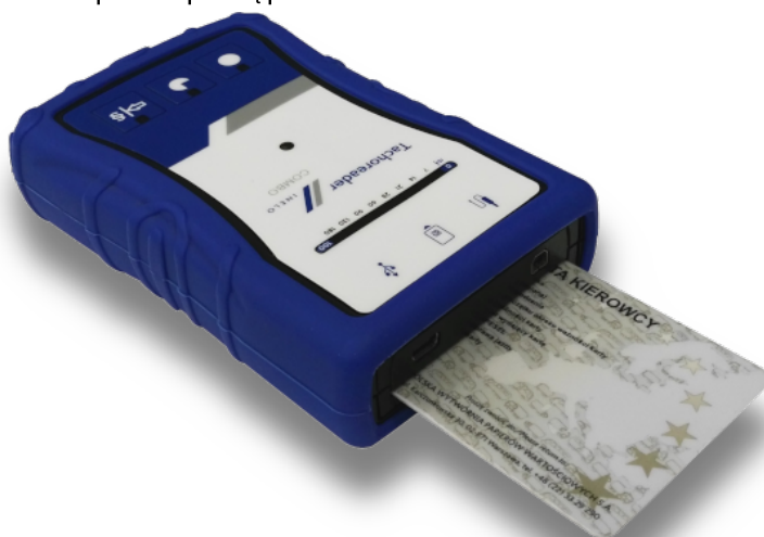
Rys. TachoReader Combo Plus - wkładanie karty kierowcy.
