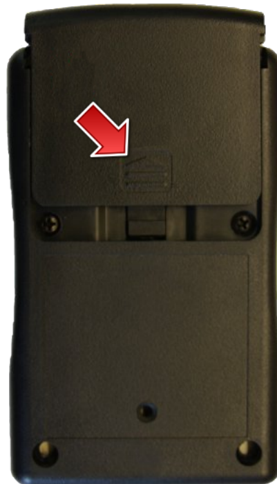
Abb. TachReader Combo - Batterien austauschen.
